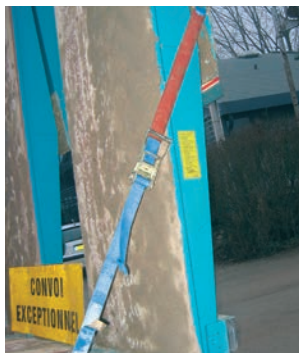
Arrimage de rampes de porte-char
