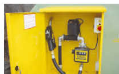
Groupe de transfert 70 L/min protégé par une armoire fermant à clé
